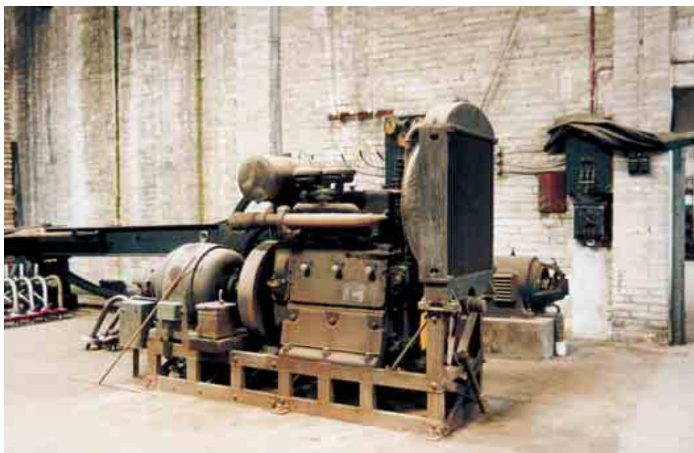
57. Nau número 10. Motor de tres cilindres amb dinamo per a produir llum en cas de restricció elèctrica. Any 1995. (Fotografia: Oriol Saula. AFMCUT)
