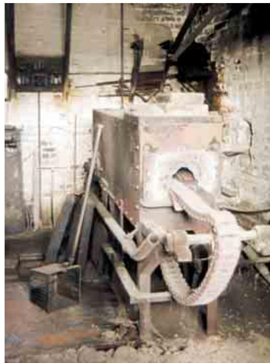
39. Nau número 6. Al fons trobem el forn de trempar els tallants de les segadores. Funciona a base d'un cremador de gasoil. L'accionament de la cadena alimentadora és elèctric. Any 1995. (Fotografia: Oriol Saula. AFMCUT)
