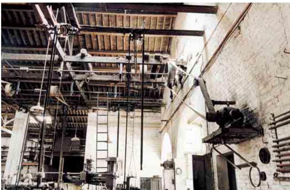
31. Nau número 5. Detall de l'embarrat accionat per un sol motor. Al fons hi ha un altre motor que s'acciona en cas d'avaria del primer. Any 1995. (Fotografia: Oriol Saula. AFMCUT)
