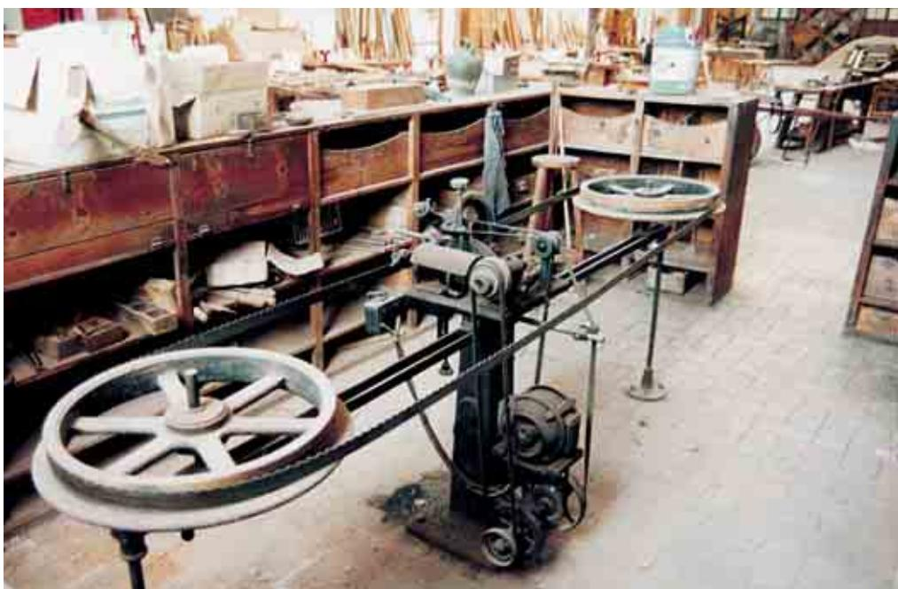
70. Nau número 17. Zona de l'encarregat de la fusteria. En primer terme, la màquina afiladora de les serres de cinta. Any 1995. (Fotografia: Oriol Saula. AFMCUT)
